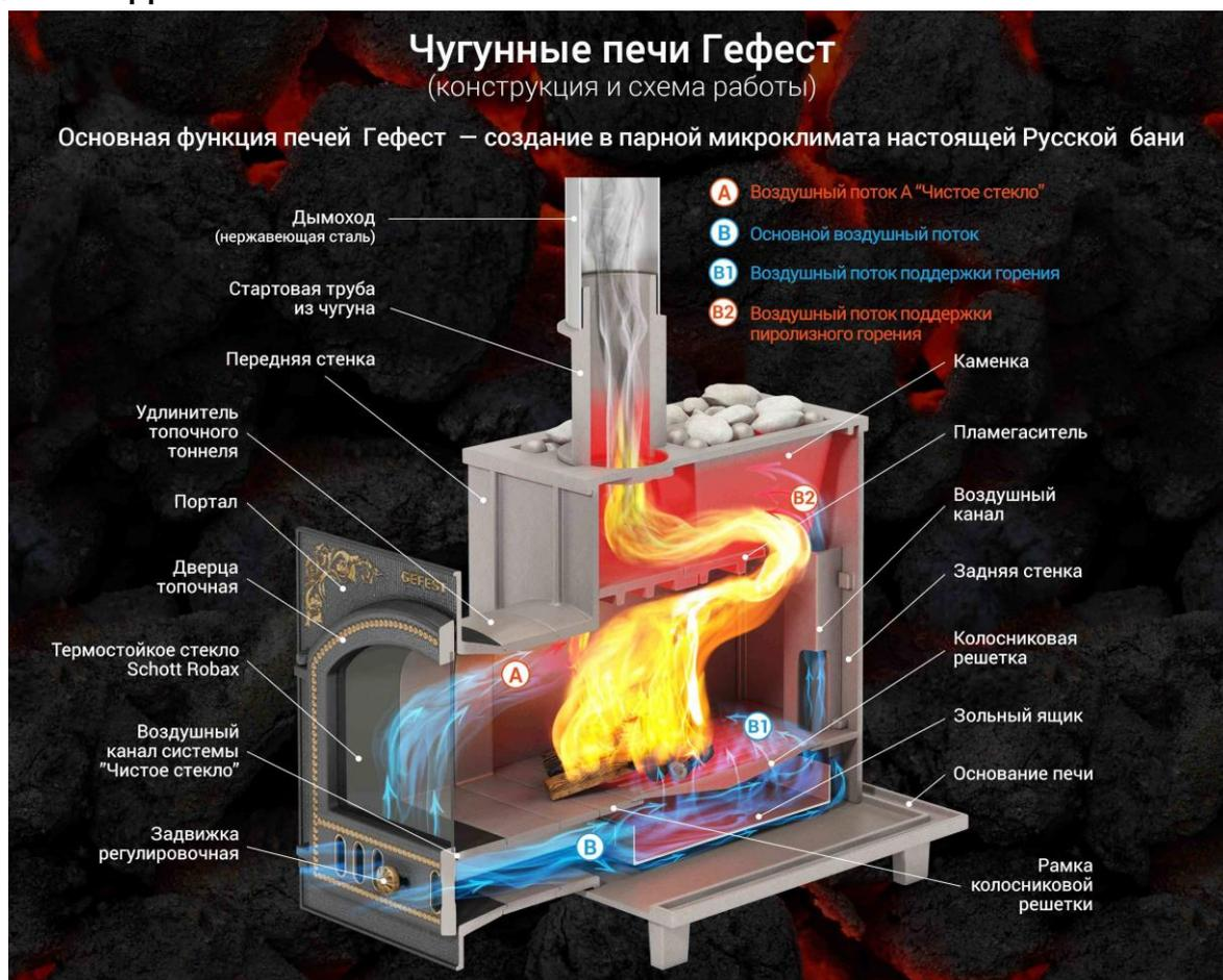
**КАК РАБОТАЕТ ПЕЧЬ ГЕФЕСТ?** Печь Гефест имеет 2-х камерную топку, с системой активного дожига пиролизных газов. Кислород проходит через воздушную заслонку дверцы и распределяется на два самостоятельных потока:
